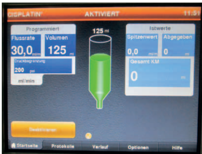
Abb. 2: Programmierung der MARK 7-Pumpe
