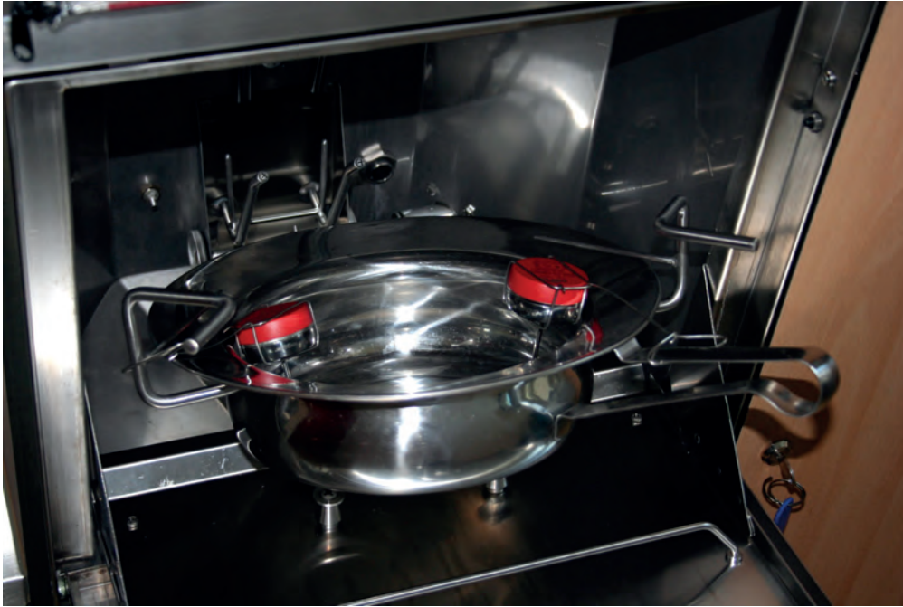
Abb. 3: Überprüfung der thermischen Desinfektionsleistung eines Reinigungs- und Desinfektionsgerätes für Steckbecken mittels zweier Temperaturdatenlogger © A. Hofmann
