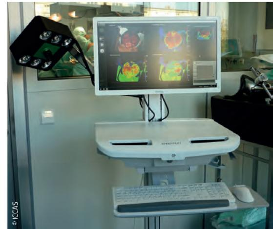
Abb. 1: Aufbau der Hyperspektral-Kamera (TIVITA™ Tissue T2- Kameranystem) mit Monitor zur Beurteilung der Anastomosenperfusion.
