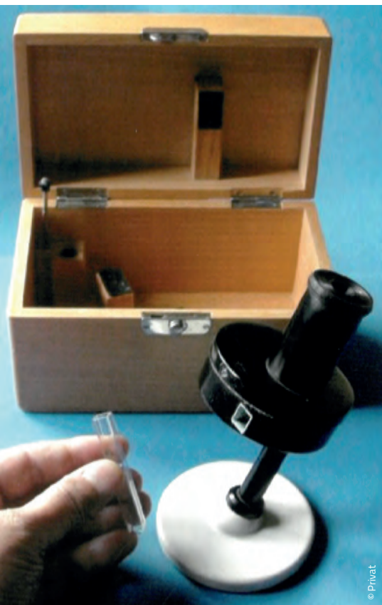
Abb. 2: Blutzucker-Kolorimeter nach Crecelius-Seifert
