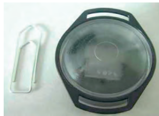
Abb. 2: So klein und auch sehr kostengünstig (etwa 30 Euro inklusive Auswertung) sind die Radonmessgeräte für die gesetzlich geforderten Langzeitmessungen.
