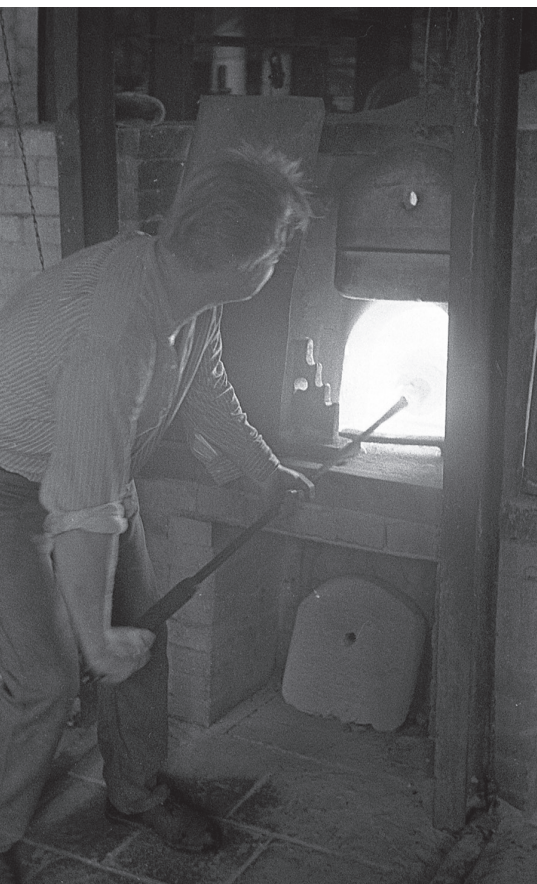
Abb. 3: Typische Entnahme der Glasschmelze. Mit freundlicher Genehmigung der Farbglashütte Lauscha/Thür. GmbH & Kunstglasbläser John Zinner
